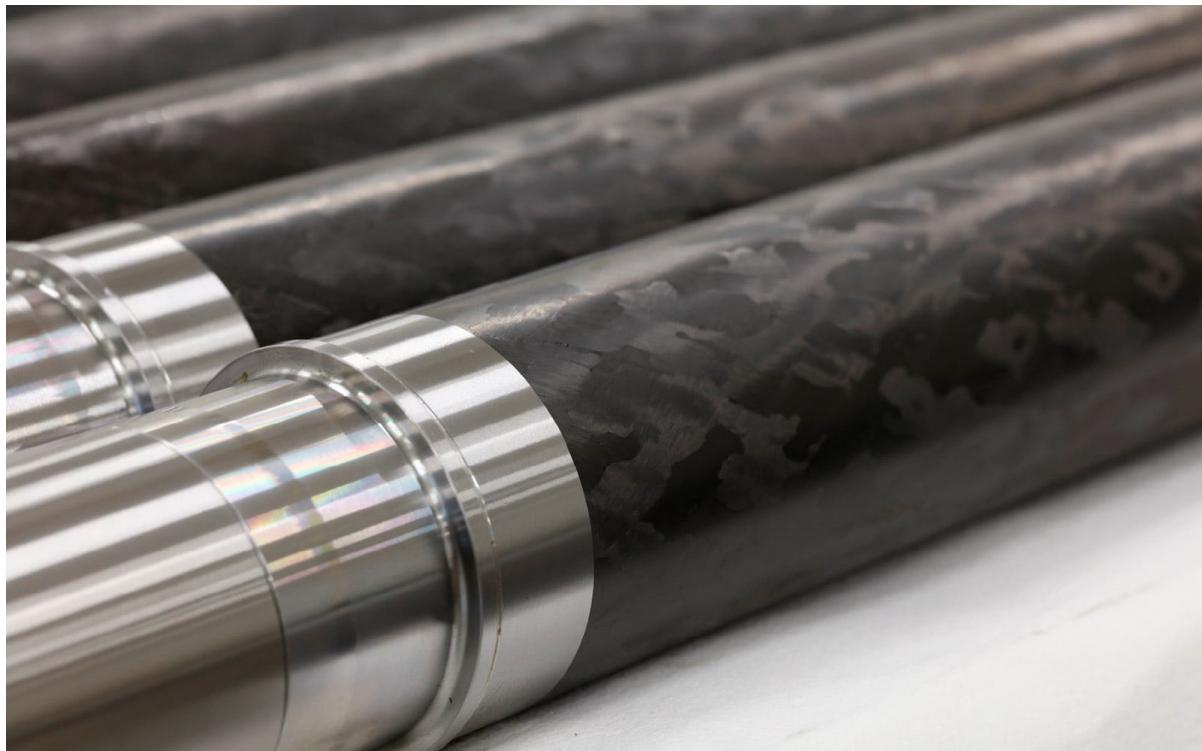
Il rullo studiato per le macchine di trasformazione della carta, del tessuto e del nonwoven, unisce elevata rigidità ad una notevole leggerezza e quindi deformazioni ridotte anche sotto la tensione del film che gira nell'impianto. Il tutto garantisce un'elevata qualità in termini produttivi e qualitativi. Fibercompositi costruisce cilindri per il converting, con diametri fino a 300 mm e lunghezze di tavola fino a 7 m.
